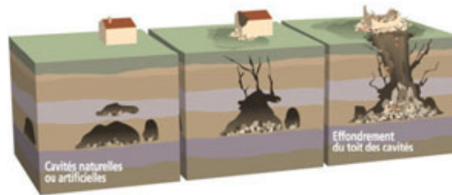
Figure 57 : Effondrement au niveau d'une cavité souterraine (source : MEDD-DPPR)
